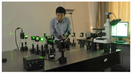
成。用于光镊技术的开发应用及微纳颗粒如有机半导体材料、生物医药样本、金属粉末等的组装、筛选与操控。图为陶少华教授在操作该系统。
