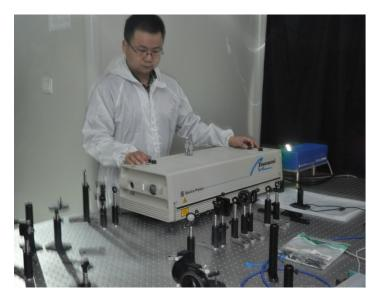
美国 Spectra-Physics,Tsunami 3941-30-X1S,脉冲宽度小于 30 飞秒,重复频率 80MHz,与超高真空低温表面分析系统配套提供飞秒级时间分辨能力。图为肖思老师正在调整飞秒振荡器。
