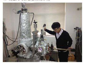
LT-STM, 无锡匡泰,由科学院物理所吴克辉研究员研发,用于在液氦温度下的隧道扫描显微成像以及隧道扫描谱的测量。横向分辨率 0.01 nm,纵向分辨率 0.001 nm。图为黄寒教授在操作低温隧道扫描显微系统。
