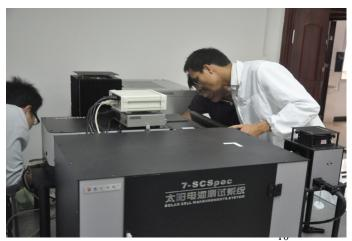
北京赛凡光电仪器有限公司 SCSpec 系统,主要用来测试太阳能电池的光谱响应、量子效率或 IPCE,光谱反射率和电流密度。图为阳军亮研究员指导我所研究生在操作该测试系统。
