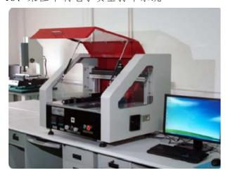
IJPAS300 是昆山海斯电子有限公司研发并于 2012 年推出的第二代印刷电子喷墨打印系统。主要用于逻辑线路,有机薄膜晶体管,太阳能电池,发光二极管等柔性器件的打印加工制备以及打印墨水的研究。
