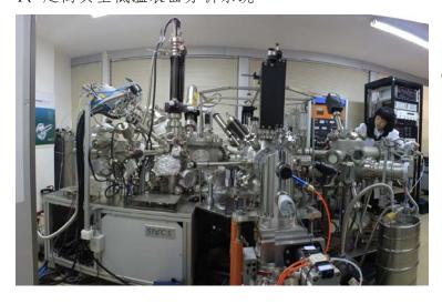
了高单色 x 光光源(Specs Focus 500),高亮度紫外光源(Specs UVLS),差分离子源(Specs IQE 12/38), 低能量电子衍射(Specs ErLEED 100/R6),反光电子能谱仪等。图为牛冬梅教授在操作该系统。
