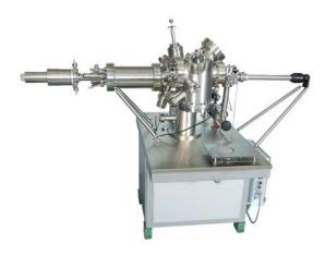
PEEM,德国 Omicron, Compact PEEM UHV, 光发射电子表面显微成像,横向分辨率为 20 纳米,用于结合飞秒激光器系统进行时-空电子结构显微成像。图为光发射电子显微镜。
