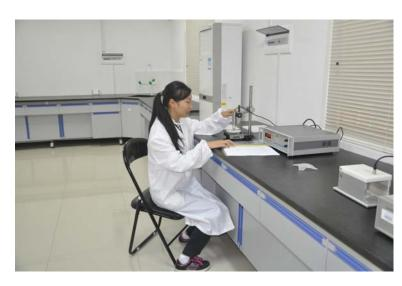
(3) 荧光光度计 (F-2500, HITACHI), 用 于测试材料光致发光与 上转换性能测试。图为我 所研究生在测试材料的 上转换性能。
